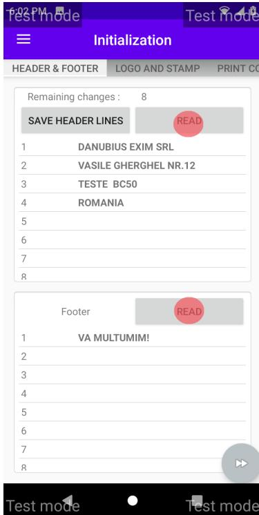
Pentru modificarea Antetului sau a Textului Final trebuie sa initiati citirea valorilor existente in imprimanta fiscală ( **READ** din sectiunea Header si respectiv **READ** din sectiunea Footer). Dupa introducerea valorilor dorite in cele 10 linii puse la dispozitie de editorul DudeAndroid POS, apasati **SET HEADER LINES** si confirmati cu **YES**. Modificarea liniilor din Footer vor fi salvate imediat.
