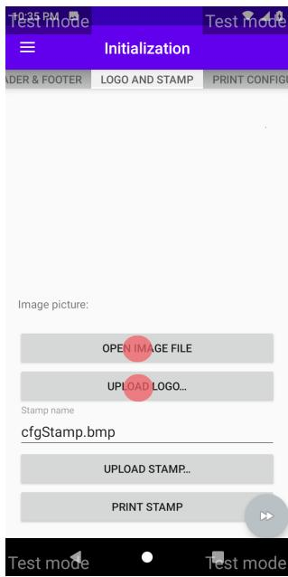
Acest panel permite incarcarea unui logo personalizat in format BMP monochrome ce va fi printat pe fiecare bon fiscal. Dimensiune 384 X 384 pixeli. Echipamentul vine cu un logo presetat care se poate inlocui.
